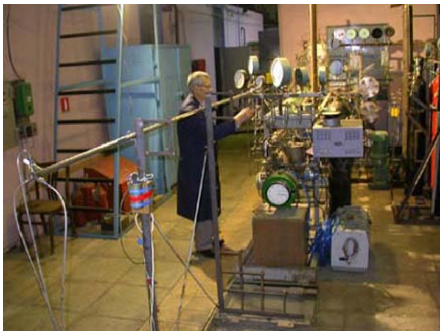
Рисунок 1.2 – Общий вид стенда с ударной газодинамической трубой
